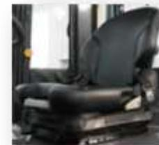
O novo assento está em conformidade **com o padrão ISO 3691**: Todos os movimentos hidráulicos e a transmissão são de corte quando não há operador no assento, incluindo um alarme se o freio manual não estiver ligado quando o operador
